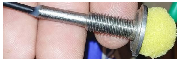
Slika 2. Industrijski mikroskop ugrađen u kućište za montažu
