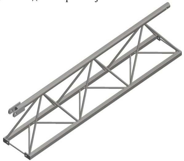
Слика 11. 3D модел једног сегмента стреле
