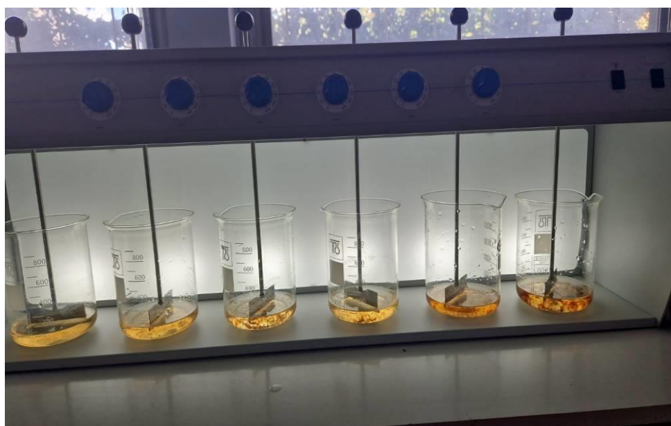
Слика 1. Џар тест – комерцијални коагулант у узорцима подземне воде (Фото: Аутор)
