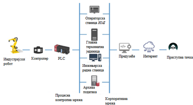
Слика 1. Архитектура SCADA система [12]
