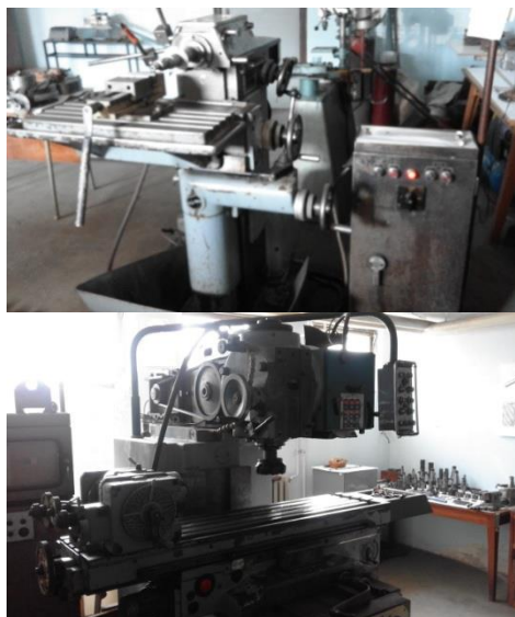
Slika 1. Alatna glodalica ALG 100 C i univerzalna glodalica HVG 2 P
